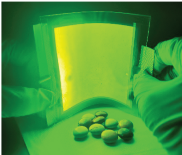
图 8 大面积柔性 OLED 器件 Fig.8 Large area flexible OLED device
